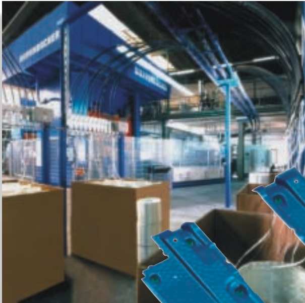
LFT-D-Anlage mit einer 30 000 kN High-Speed Presse, ausgerüstet mit aktivem Parallellaufsystem
