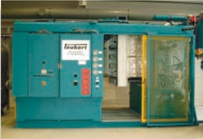
Formteilautomat TVZ125/85 im Technikum (Bild: Neue Materialien Bayreuth GmbH)
