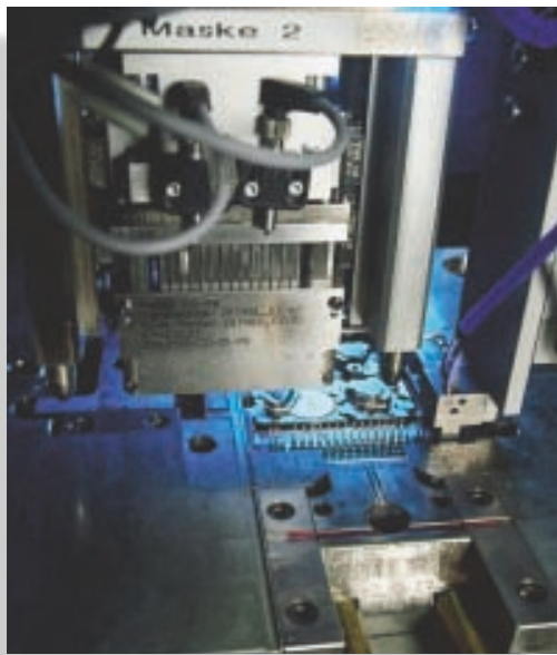
Während sich die geschlossene Kavität im Spritzprozess befindet, bestückt ein Handlingsystem die freie untere Werkzeughälfte mit 47 Pins und zwei Gewindebuchsen.
