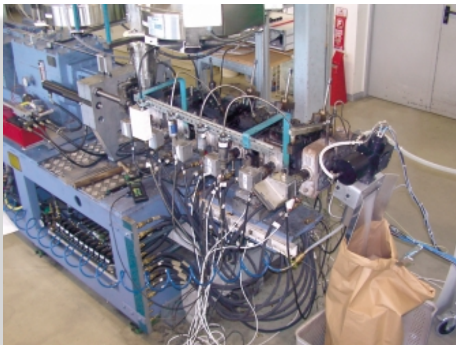
Der Anwender kann den Sensor über einen entsprechenden Adapter an den Spritzkopf des Extruders installieren.
