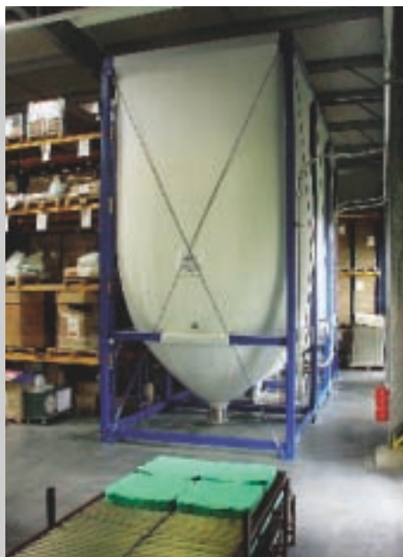
Austragshilfe für Kunststoffrecyclingprodukte wie PET-Flakes (Bilder: A.B.S.)
