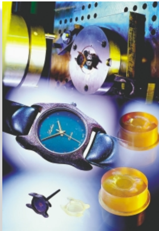
Lasergesinterte Formeinsätze ermöglichen es, bereits kurze Zeit nach Fertigstellung der CAD-Daten serienähnliche Teile herzustellen. (Bild: FhG-IPT)
