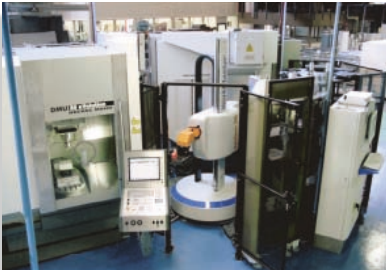
Die komplette Zelle bei geöffneter Servicetür. Links und hinten die beiden Fünfachsen-Fräsmaschinen, in der Mitte der Workmaster-Roboter, rechts das Werkstückmagazin
