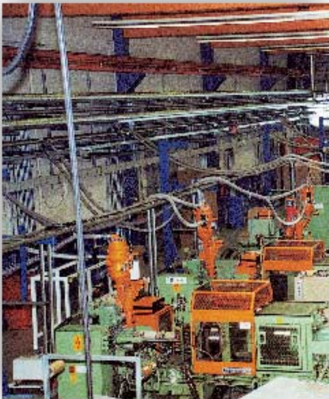
In der Maschinenhalle sind die Spritzgießmaschinen mit Farbmischgeräten für Granulate ausgerüstet (Bilder: Koch)
