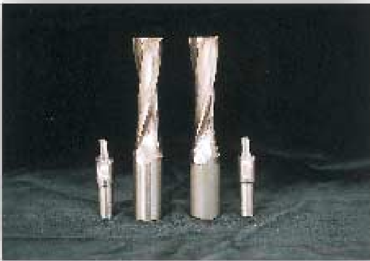
Hochleistungserspanungsfräser für die Bearbeitung von GFK. Sie unterscheiden sich von Standard-HM-Werkzeugen durch eine besonders lange Standzeit
