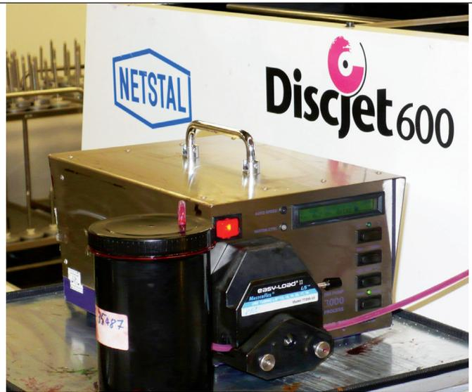
Effektive Dosiertechnik für Flüssigfarben: Eine peristaltische Pumpe, die eine geschlossene Dosierung der Farbe ermöglicht.
