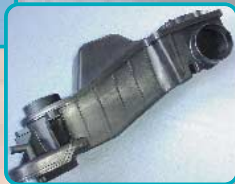
Saugseitiger Resonator der 4-Zylinder-Kompressor-Motoren
