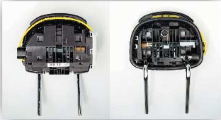
Kopfstütze mit integriertem pneumatischem Entriegelungssystem
