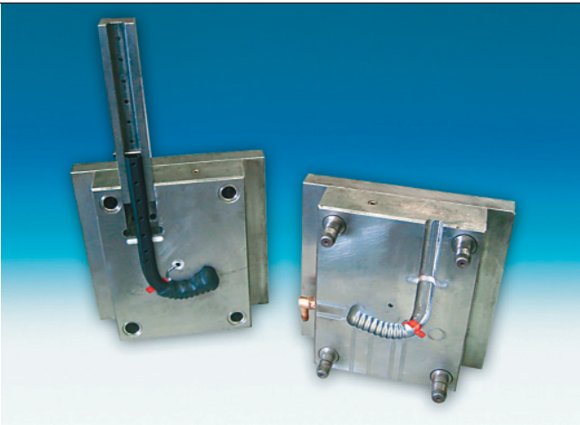
Umspritzen eines Rollstuhl-Schiebegriffes aus eloxiertem Aluminium mit TPE; eine technisch und wirtschaftlich überzeugende Lösung, unter anderem möglich durch flexible Dichtelemente (rot) hoher Reversibilität im Werkzeug.
