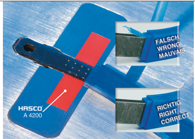
Prinzipielle Falsch-Richtig-Darstellung (mit beziehungsweise ohne Grat) des Umspritzens von Einlegeteilen, wobei neuartige Kunststoff-Dichtelemente (rot) im Werkzeug unter anderem die Gratbildung verhindern. (Bilder: Hasco)
