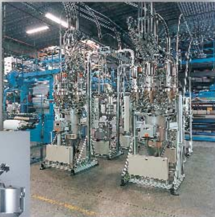
Beim Dosiersystem Azograv ist die Hauptkomponente in der Mitte angeordnet und die Nebenkomponten sind sternförmig angeordnet
