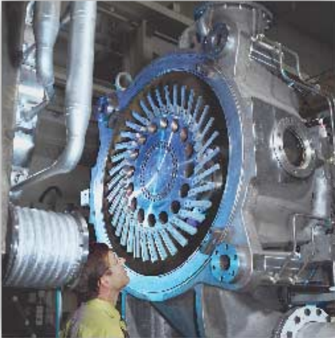
Die geöffnete Unterwassergranulierung UG 1000 – sie ist für Durchsätze bis 75 000 kg/h bei Polyolefinen ausgelegt – gibt den Blick auf den etwa 150 kg schweren Granuliermesserflügel frei
