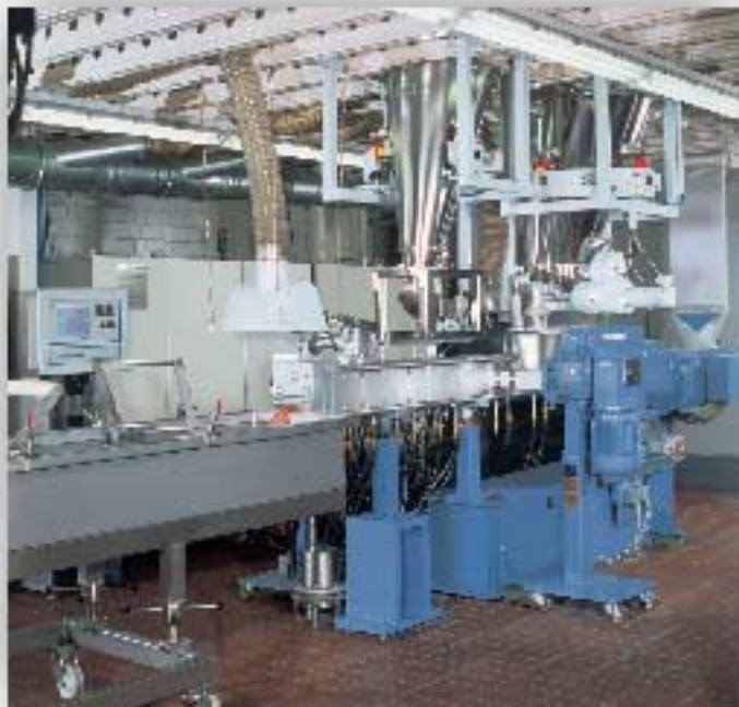
Herstellung von Masterbatch auf einem ZSK 50 Mc mit Vakuumentgasung, der für das Split-Feed-Verfahren mit einer Seiteneinspeisung ausgerüstet ist
