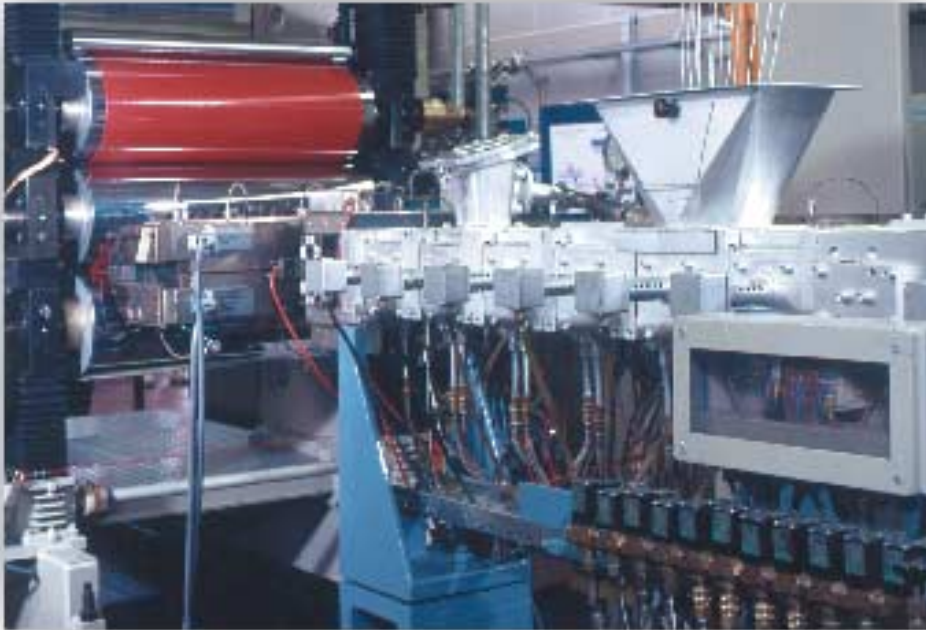
MEGAcoupler ZSK 58, ausgerüstet mit einem Direkteinzug von Glasfaser-Rovings und einem nachfolgenden Glättwerk, zum Herstellen von Kunststoffplatten mit Glasfaserverstärkung
