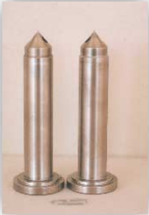
Durch die Innenveredelung von Molybdän-Heißkanal-Spritzgießdüsen ließ sich die Standzahl bei der Verarbeitung von mit bis zu 70 % Glasfaseranteil verstärkten Kunststoffen im Vergleich mit unbeschichteten Düsen um das 26fache erhöhen (Bilder: Technisches F&E-Zentrum, Schömborg-Langenbrand)
