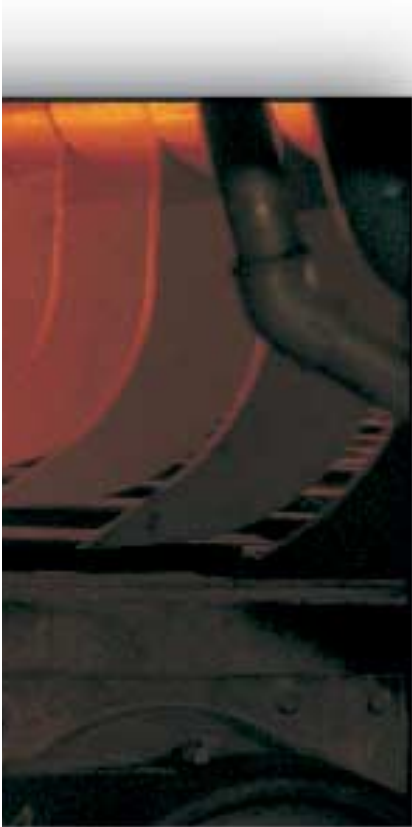
Ein glühender rollender Zylinder – das Schleudern von Bimetallzylindern stellt höchste Ansprüche an das Verfahrensknow-how
