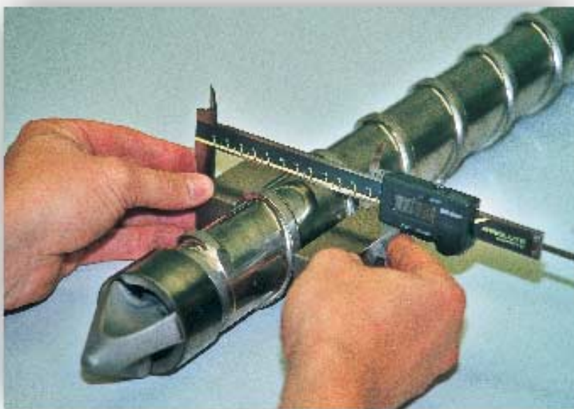
Messung des Außendurchmessers einer Marathon-Schnecke von Engel (Bilder: Blum, Höchst; Engel, Schwertberg; Plastikverarbeiter)
