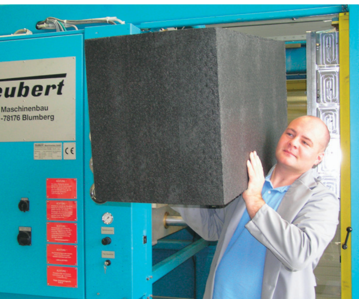
Erster konventionell hergestellter EPP-Block mit 500 mm Dicke (Dichte etwa 40 g/l)
